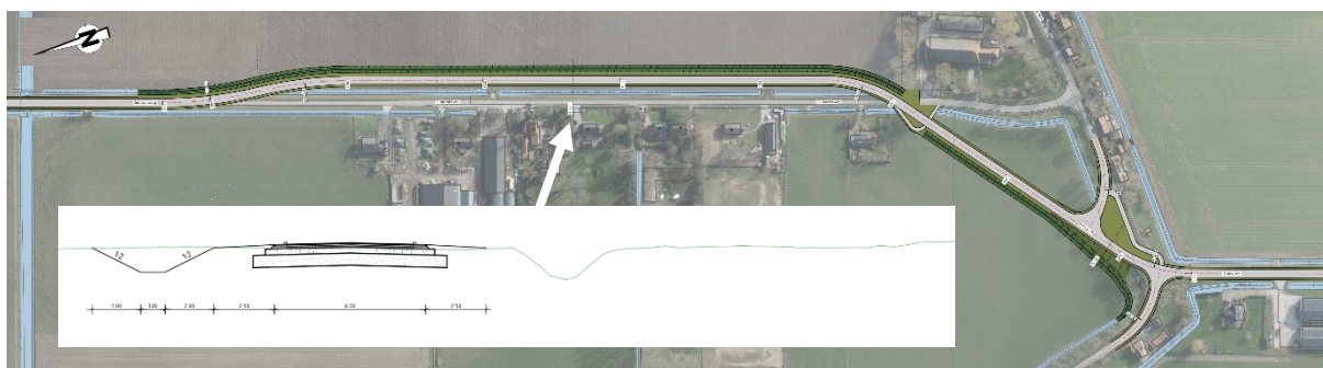
Figuur 12 – Tracé van Variant A+ met principe dwarsprofiel ter hoogte van de verlegde Zuidoordseweg
