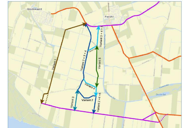
Figuur 8 - Tracévarianten met mogelijke optimalisaties (gestippeld)
