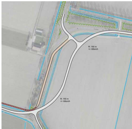
Figuur 3.8: ontwerp met boogstraal van 150 m, passend bij een ontwerpsnelheid van 60 km/u
