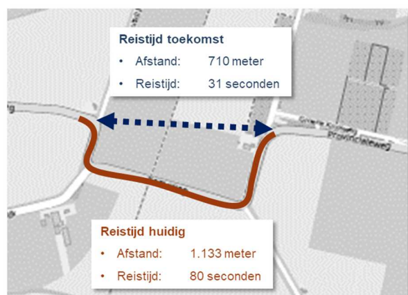
Figuur 4.1: Vergelijking afstand en reistijd autoverkeer
