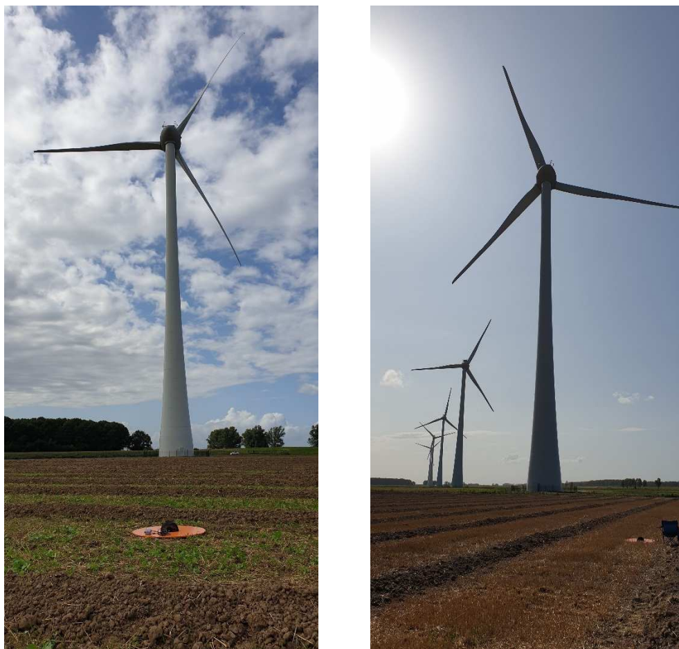
figuur 2 weergave van de meetopstelling bij windturbine 1 (links) en windturbine 5 (rechts)
